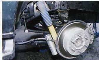
L'amortisseur arrière dispose d'un réservoir de gaz accolé au corps.
