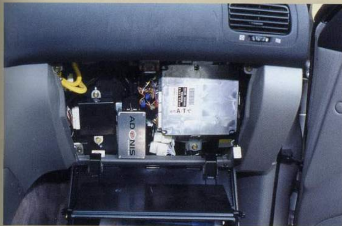
Le calculateur Toyota et le boîtier Adonis ; celui d'origine n'est pas modifié, le "booster" vient en complément pour optimiser les données constructeur.
