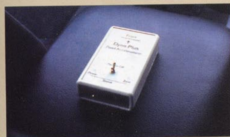
L'accéléromètre permet de rentrer toutes les données du véhicule, poids, diamètre des roues, CX... pour des mesures très précises.
