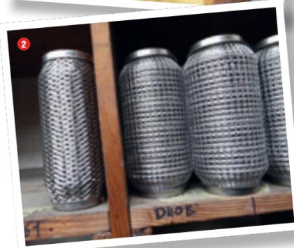
1 et 2) Une petite partie des flexibles d'échappement conçus spécialement par Tecinox.
